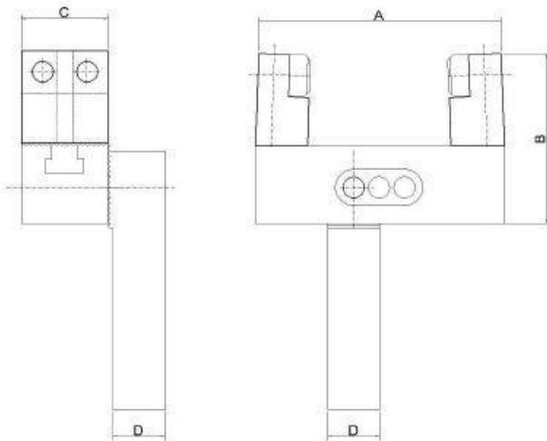
**O Puxador de barras proporciona grande robustez e fácil regulação. Seus patins de fixação são deslizantes com sistema de regulação de pressão automática facilitando o posicionamento dos mordentes sobre a peça.**
